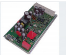
Speziell für Anwendungen im Bahnverkehr entwickelte Autronic einen DC/DC-Wandler für Datenlogger, der den Anforderungen und Standards der Branche entspricht. (Bild: Emtron/Autronic)
