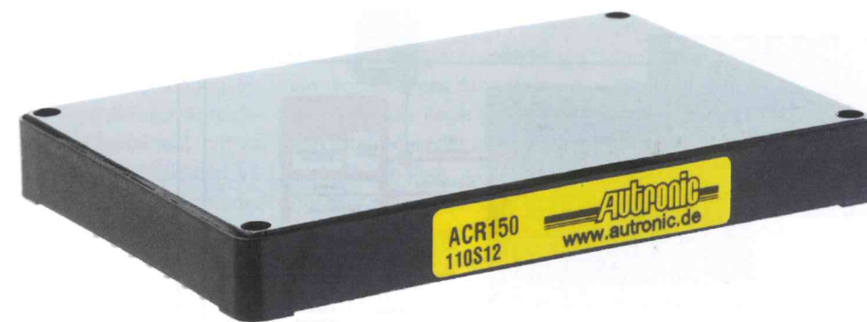
2 Das Wandlermodul ACR150 arbeitet mit einer Leiterplattentechnologie aus Aluminiumsubstrat und erzielt eine hohe Leistungsdichte mit einem Wirkungsgrad von über 90%.
