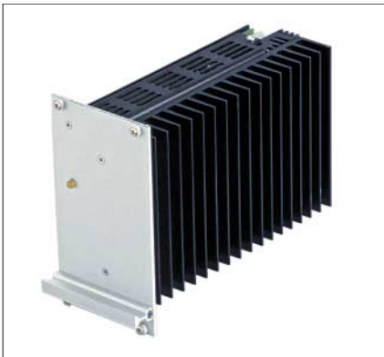
Bild 2: Eine zusätzliche Lackierung schützt die Wandler der AVP/KEP-Serie im 19" Gehäuse vor Verschmutzung, Feuchtigkeit und Salznebel – eine optionale Forderung der EN 50155.
